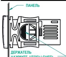
Контроллер XR10CX должен монтироваться на вертикальной панели в вырез 29x71мм и закрепляться, используя поставляемые специальные держатели.
