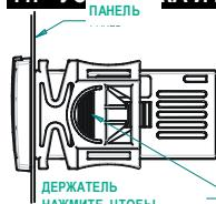
Контроллер XR20CX должен монтироваться на вертикальной панели в вырез 29x71мм и закрепляться, используя поставляемые специальные держатели. Диапазон температур, разрешенный для правильной эксплуатации - 0÷60°C. Избегайте мест, подверженных сильной вибрации, с присутствием агрессивных газов, чрезмерной запыленности или влажности. Те же рекомендации применяйте и к датчикам. Позвольте воздуху циркулировать через отверстия для охлаждения..
